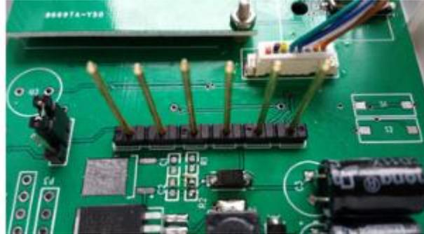
对准接线柱排针，将前盖合上
